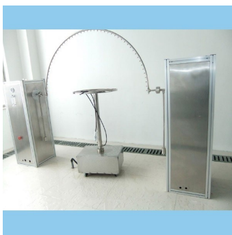
Стенд для определения степени защиты от дождя и обрызгивания воды по ГОСТ 14254-96, МЭК 529-89 MT 440/1
