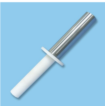
Щуп для проверки защиты людей от доступа к опасным механическим частям. МТ-237
