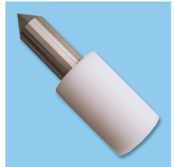
Щуп для проверки защиты людей от доступа к горячим или накалившимся частям МТ 239
